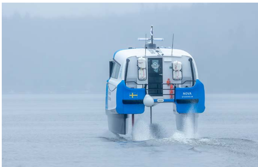
Flyger. Nova är av typen Candela P-12, världens första elektriska passagerarfartyg med bärplan.
