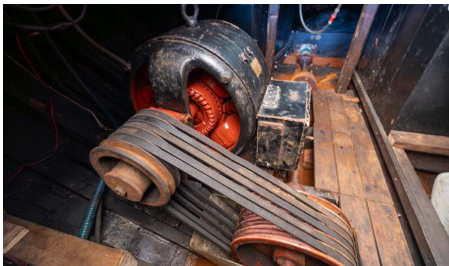
Maskin. Spårvagnen drivs av en motor på 8 hk (Asea) och har 40 batterier som ger 80 volt.
