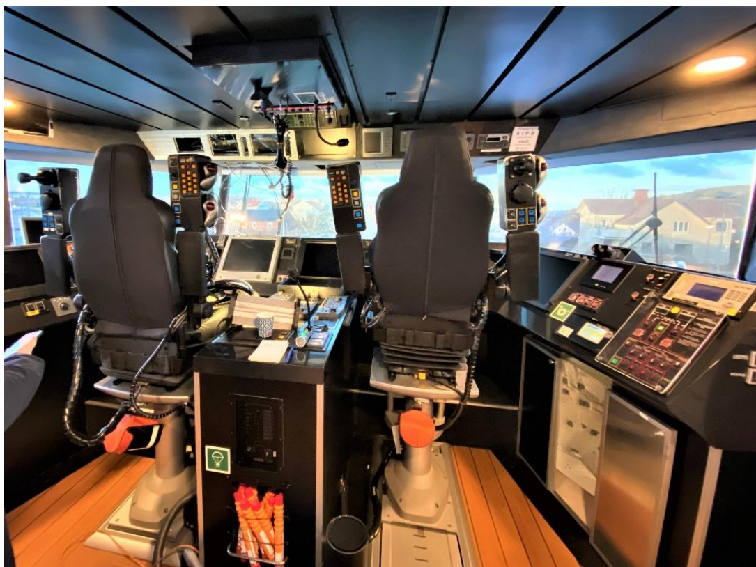
Figur 6. Styrhytten på snabbfärjan VALÖ. Två navigatörer sitter bredvid varandra med varsin uppsättning av instrument och kontroller för navigation och framförande.
